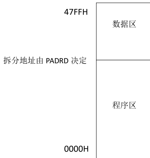
图 7-3-1 18K Flash 存储器结构
